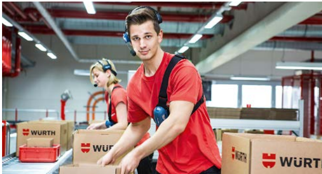
Pick-by-Voice: Im neuen Logistikzentrum West arbeitet Würth mit Sprachkommissionierung. Aufträge werden vom Lagerverwaltungssystem mittels WLAN an den Kommissionierer übermittelt.
