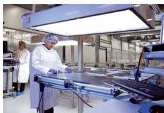
CIS-Module von Würth Solar bei einer visuellen Inspektion
